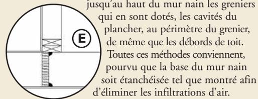
jusqu'au haut du mur nain les greniers qui en sont dotés, les cavités du plancher, au périmètre du grenier, de même que les débords de toit. Toutes ces méthodes conviennent, pourvu que la base du mur nain soit étanchéisée tel que montré afin d'éliminer les infiltrations d'air.
