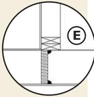
Enlevez tous les anciens matériaux isolants (copeaux de bois, zostère marine, mousse de tourbe, etc.) du périmètre où le débord de toit limite la quantité d'isolation. Remplacez-les par de l'isolant rigide ou soufflé afin d'accroître la résistance thermique.
